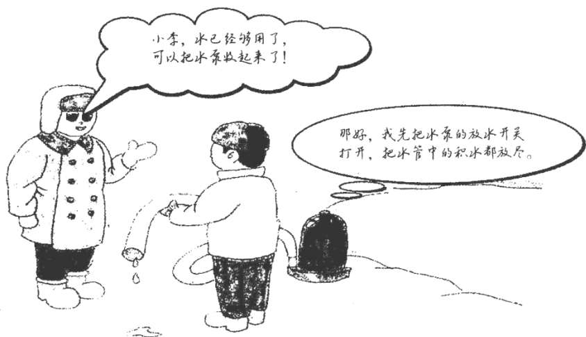
冬季作业停机的事，应将各部的放水开关拧开，把水泵水管中的积水放尽
