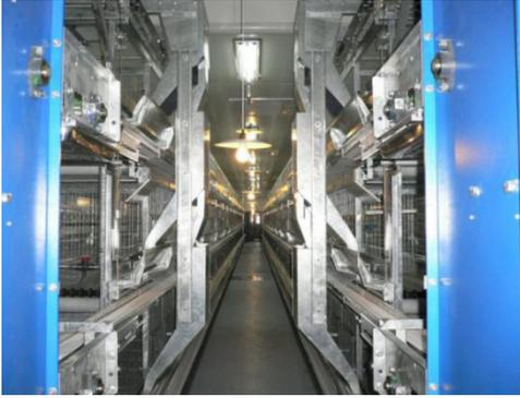
图4 行车喂料机结构
