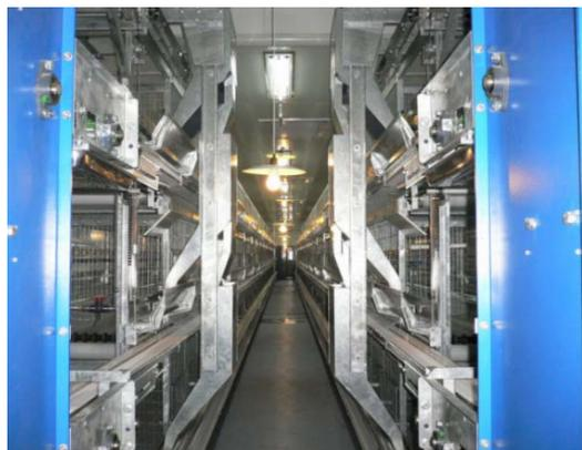
图3 行车喂料机结构
