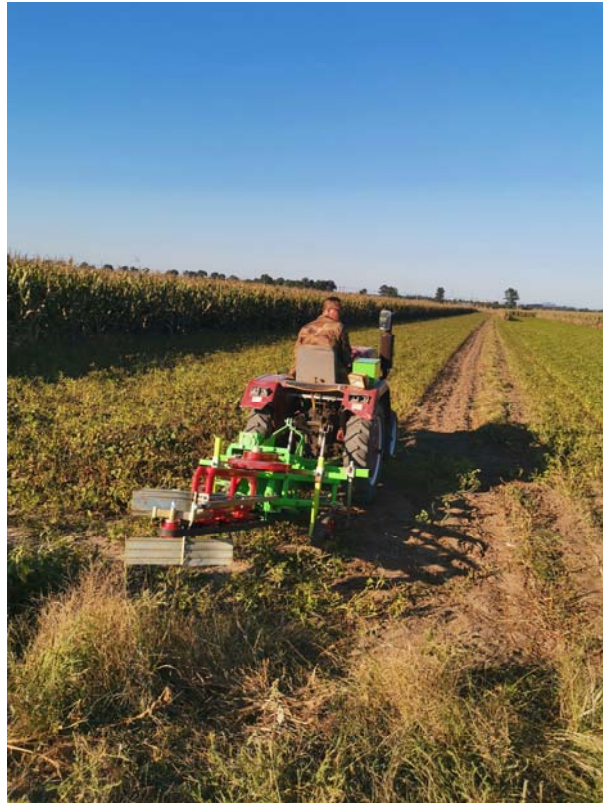
图三 花生挖掘机作业
