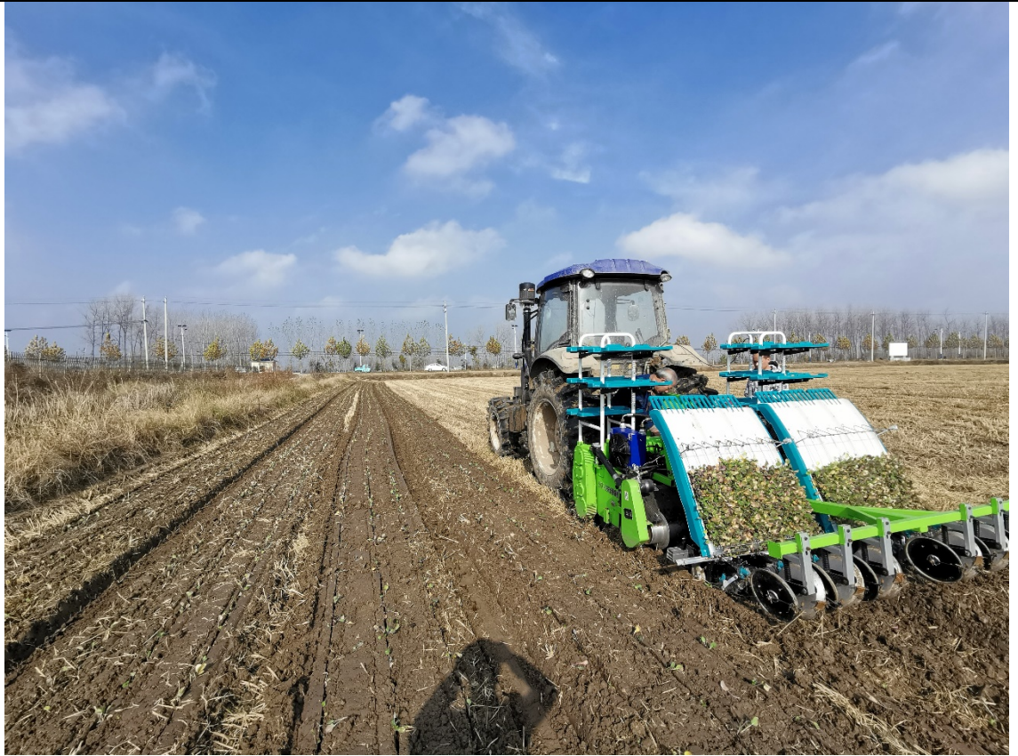
图片 7 使用油菜毯状苗联合移栽机移栽
