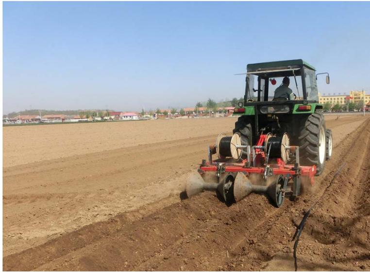
图3 机械化旋耕起垄铺滴灌带技术
