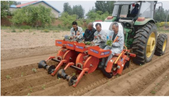
图 1 2CGF-2 型甘薯移栽起垄复式作业机
