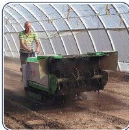
▲ 图4 MSX650M型履带自走式撒肥机
