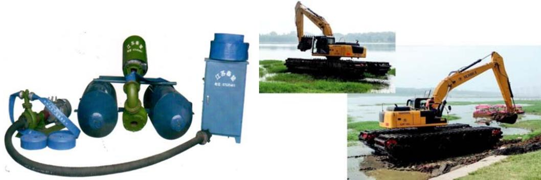
图 1：清淤机和履带挖掘机
