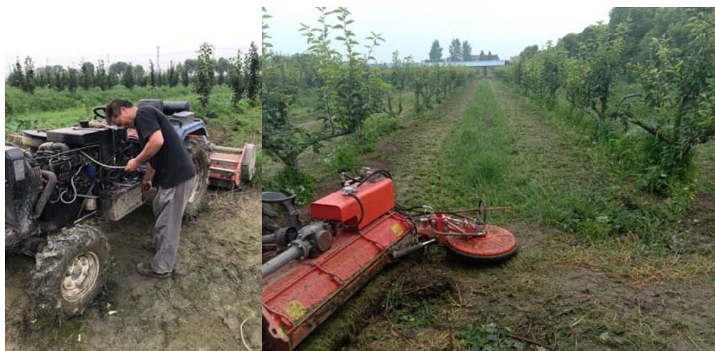
拖拉机油管爆裂
